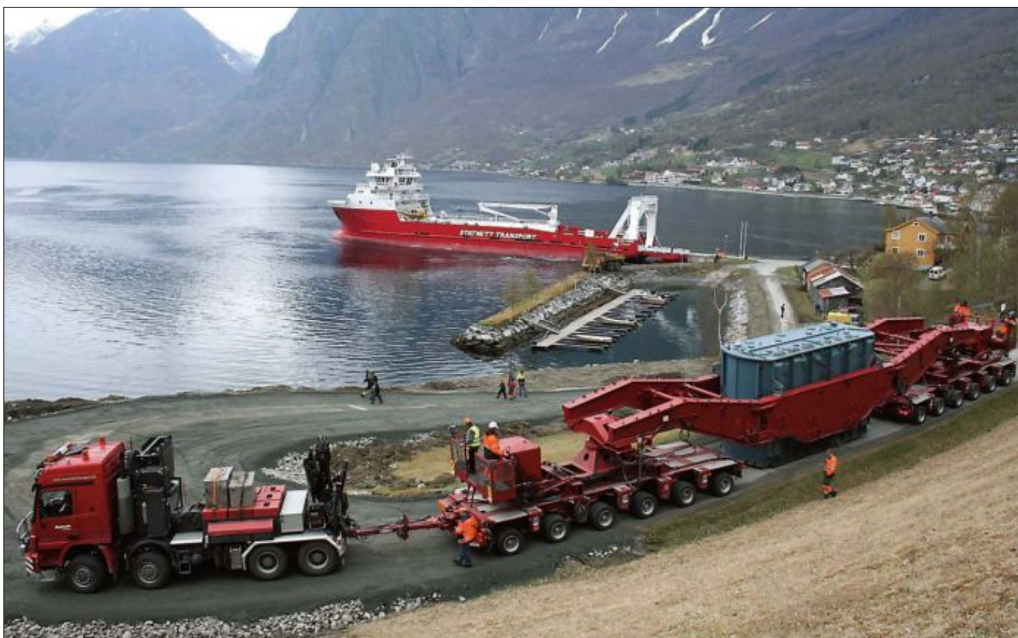
TUNG OG BREITTRANSPORT: Spesialtransport frå Statnett måtte til for å frakta transformatoren frå og til kaien ved Aurlandsfjorden. Her frå transporten i april i fjor. (Foto: Arne Veum)
